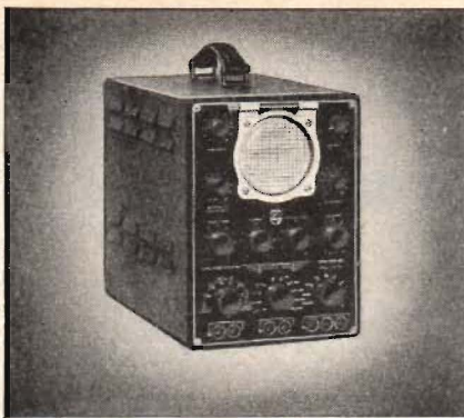
Laboratorieoscillografen GM 3156 med 90 mm skärm. Frekvensområde 0,1–10 000 p/s. Kan levereras med efteraccelerationsrör för studium av snabba förlopp. Känslighet 1 mV/cm bildhöjd. Vippfrekv. 0,25–2000 p/s. Pris 1500
