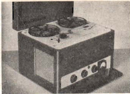
Fig. 1. Taperecorder från Ferrograph med total speltid av två timmar för frekvensområdet 70—4 000 p/s.
