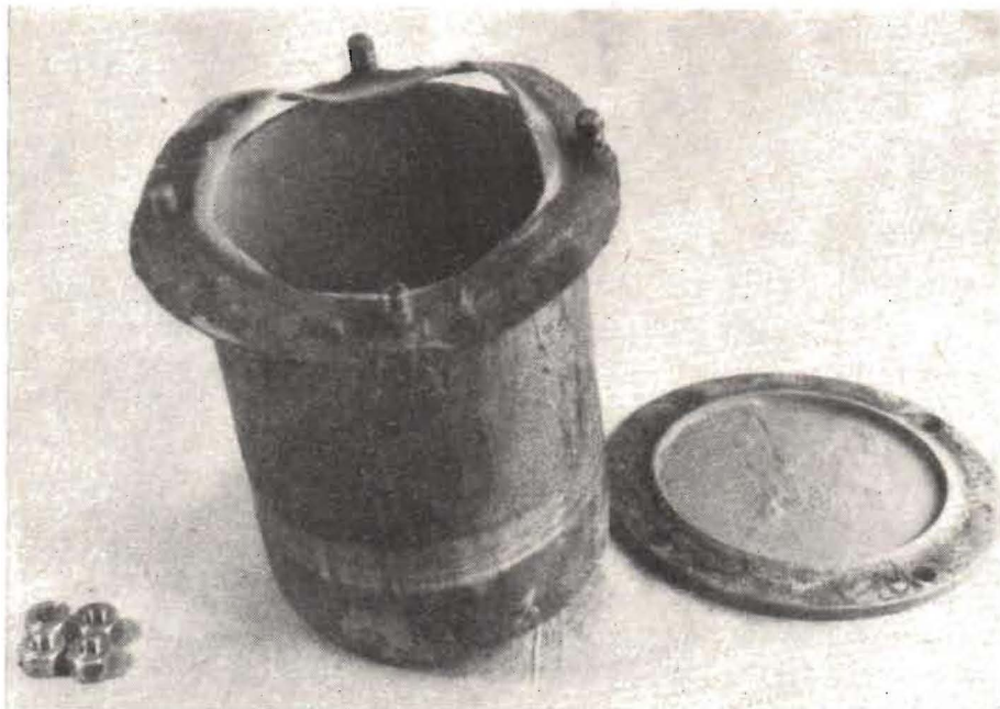
Fig. 1. Hemmatillverkad kulkvarn. Observera packningen, som måste anbringas mellan och järnbehållaren.
