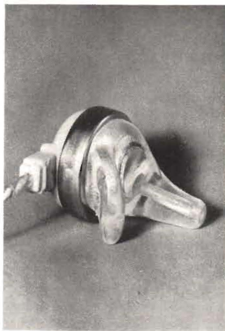
Fig. 7. Magnetisk ljudgivare i miniatyruutförande från A/S Danavox. Den är försedd med ett plastmellanlägg avsett att stickas in i örat. S. k. »örtelefon».
