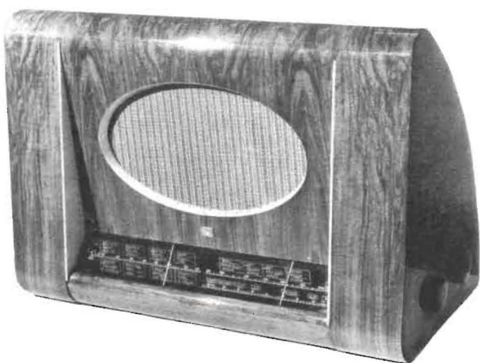
Fig. 10. Typisk engelsk rundradiomottagare från The Grammophon Co Ltd . Lång-, mellan- och kortvåg. Ingen bandspridning på kortvåg.
