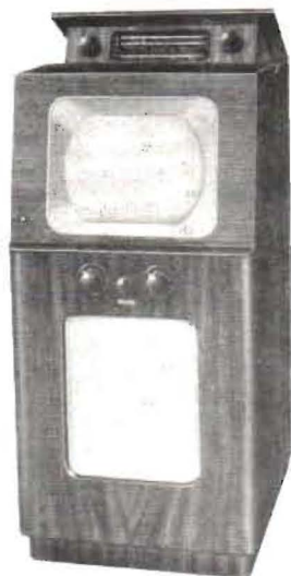
Fig. 7. »Teleradio» dvs. en TV-mottagare + rundradiomottagare, med 10" bildrör. Radiodelen är dold bakom skärmen och kan fällas upp när apparaten skall användas som rundradiomottagare. Tillverkare: Cossor.
