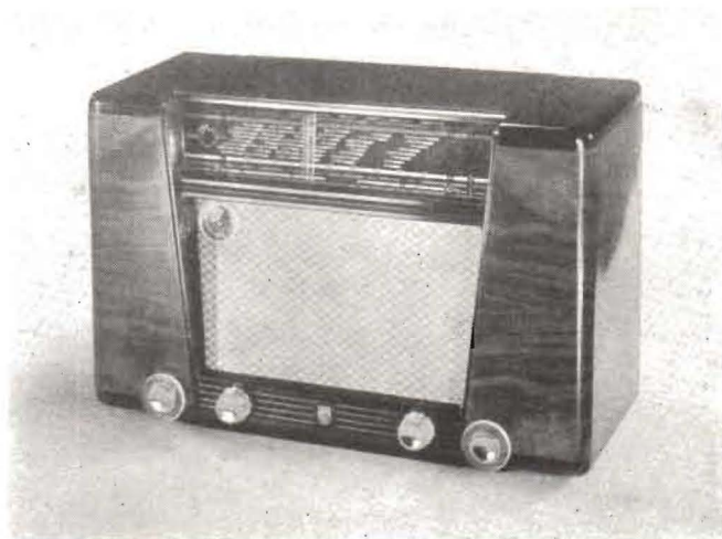
Fig. 2. Mottagare för lång-, mellan-, kort- och ultrakortvåg, med två bandspridna områden på kortvåg (25 och 30 m-bandet). Apparaten levereras i två olika utföranden, dels med UKV-tillsats inmonterad, dels utan sådan tillsats. UKV-tillsatsen omfattar 2 rör, 2 kretsar och superregenerativ detektor. Avstämningen på UKV kombineras med mottagarens avstämningsrätt och -skala.
