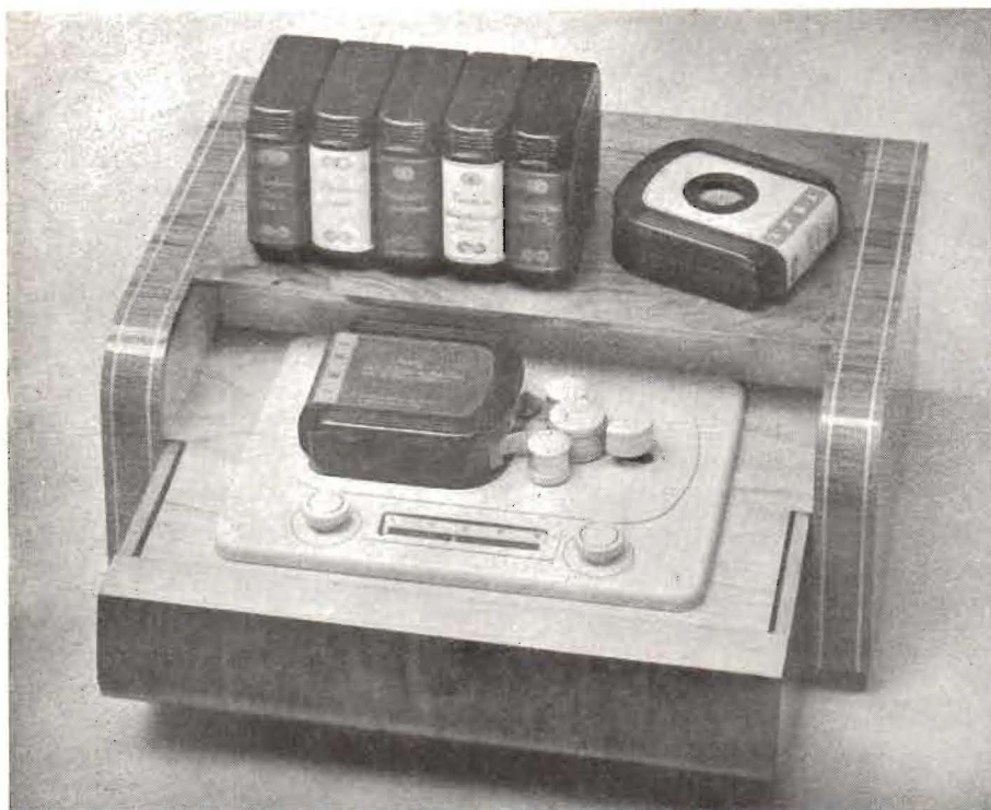
Fig. 5. »Tefifonen», sensationen på Düsseldorf-utställningen. Tefifonen är en bandspelare men med graverade spår som på en grammofonskiva. Antalet parallella ljudspår på bandet är 56. Speltiden 24, 48 eller 60 min. För förvaring av bandet användes en bokliknande kassett. Framtidens grammofon?
