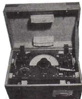
R1155, engelsk surplus. En god mottagare till mycket lågt pris, 355:—. Erfordrar 230 V=, 70 mA och 6,3 V~, 4 A. Kontant 10 % rabatt.
