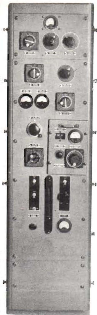
ET4336B. Amerikansk sändare, fabrikt RCA. VFO eller xtal slutsteg, modulator och likriktare. För 220 V~. Uteffekt 350 WCW, 250 Wphone.
