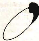
HÖG FREKVENT PARASITSVÄNGNING VID UTSTYRNINGSTOPPARNA
