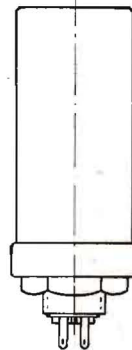
PEH 103 Med gängad sockel för enhälsmontage.
