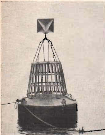
Fig. 8. Kombinerad hörnreflektor »Octahedral cluster».
