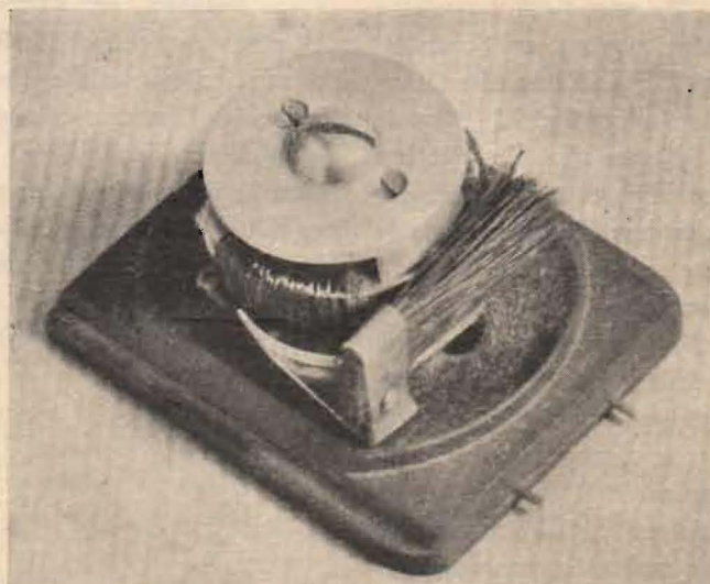
Fig. 14. Det färdigmonterade inspelningshuvudet. Huvudet är anbringat på en bakelitskiva med hjälp av en mässingskrav, som går genom gavlarnas centrumhål. En borste applicerad på bakelitskivan trycker bandet mot luftspalten.
