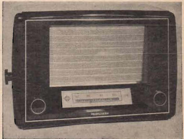
Fig. 8. Denna mottagare från Telefunken är speciellt konstruerad som UKV-mottagare. Frekvensområdet är 86—100 Mp/s. Typbeteckning UKW 6 A.
