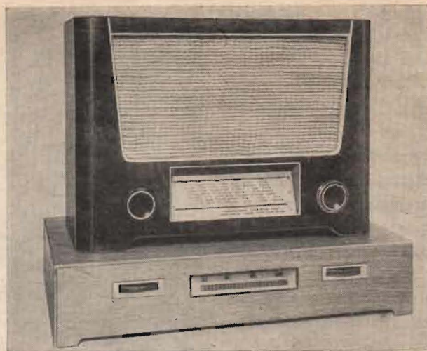
Fig. 9. (Ovan) Här har UKV-tillsatsen utformats som en i en trälåda uppbyggd konsol, på vilken den ordinarie mottagaren placeras. Tillsatsens frekvensområde är 86—100 Mp/s. Till vänster ratt för volymkontroll, till höger ratt för avstämningen.
