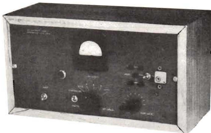
Fig. 5. Mätanordningens praktiska utförande. Omkopplaren i mitten är spänningväljaren, med vars hjälp det önskade mätområdet inställes. Tvåvägsomkopplaren skall vid den ungefärliga mätningen stå i läget »inställning». Sedan lämpligt område valts, slås omkastaren över i läge »mätning». Mätanordningen är inbyggd i en högspänningslikriktare för ett elektronmultiplikatorrör. Spänningen från högspänningslikriktaren är kontinuerligt variabel mellan 600 och 1 100 volt.
