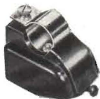
Magnetisk pick-up huvud GP7. Lätt nåltryck. Känslighet: —15 dB—25 dB mellan 40—6.000 p/s.
