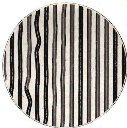
Fig. 1. Spåren i en ordinär gramfon-skiva i stark förstoring. Avståndet mellan spåren är konstant och oberoende av amplituden hos de inspelade ljudsvängningarna.
