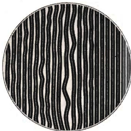
Fig. 2. Spåren i en gramfon-skiva med variabelt spåravstånd enligt det nya tyska inspelningsförfarandet. Avståndet mellan spåren är beroende av amplituden på svängningarna.
