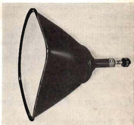
Fig. 3. Rektangulärt metallbildrör tillverkat av RCA, typ 17CP4. Bildstorleken är 370×280 mm med obetydligt krökta sidor och något avrundade hörn. Genom metallhöljet ernås en aktningvärd viktbesparing, vidare kan genom rörets form TV-mottagarens apparatlåda göras mindre skrymmande. Såväl avlänkning som fokusering är elektromagnetisk, och rörets maximala längd är cirka 460 mm.
