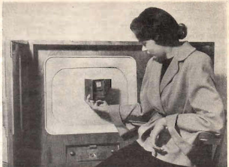
Fig. 4. Utställningens största och minsta televisionsmottagare från His Master's Voice . Skärmdiameter 21" på den stora, 1" på den lilla apparaten (som faktiskt fungerade. Avlänknings-spänningar och videospänningen togs dock från den stora apparaten).
