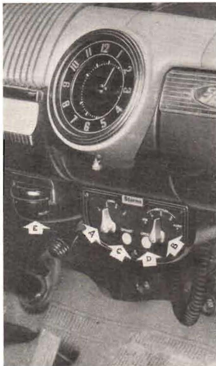
Fig. 1. Kontrollerna för biltelefon monterade under bilens instrumentpanel. E=mikrotelefonen, A=kanalväljare, C=upptagetlampa, D=signallampa, B= omkopplare för högtalare.
