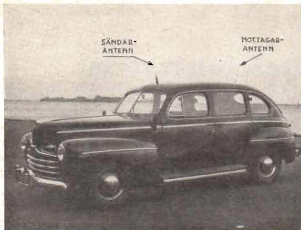
Fig. 2. Bilen förses med skilda antenner för sändning och mottagning.
