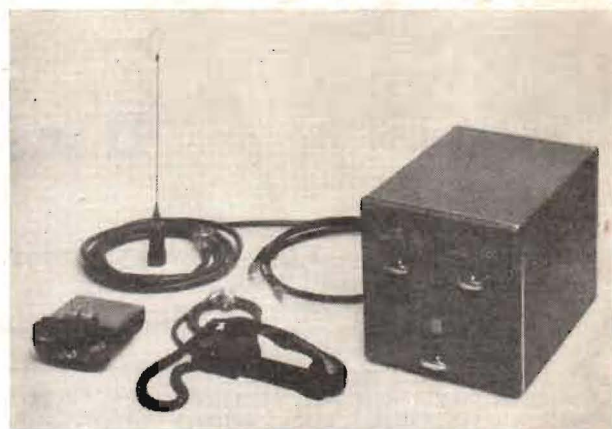
Fig. 3. Den kompletta utrustningen för radiotelefon i bil, Skåpet t. h. innehåller sändare, mottagare och kraftaggregat.
