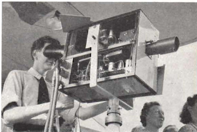
Fig. 3 (ovan). En av de TV-kameror, som de holländska amatörerna »leker» med. Kameran innehåller allt utom nätaggregat och sändaren. Fig. 4 och 5 (spalten t. h.). Prov på bildkvaliteten hos de holländska amatörernas TV-system.
