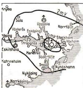
Fältstyrkekarta för Spånga rundradiostation
