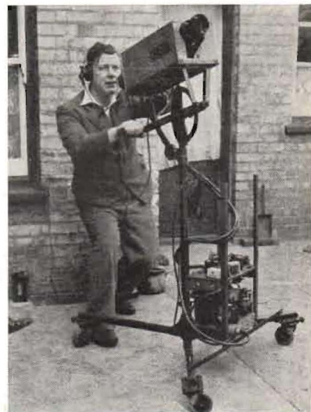
Fig. 2. Här står den engelske TV-amatören G 2 DUS beredd bakom kameran. Pulsaggregat och strömförsörjningsanordningar är monterade på kamerastativet.
