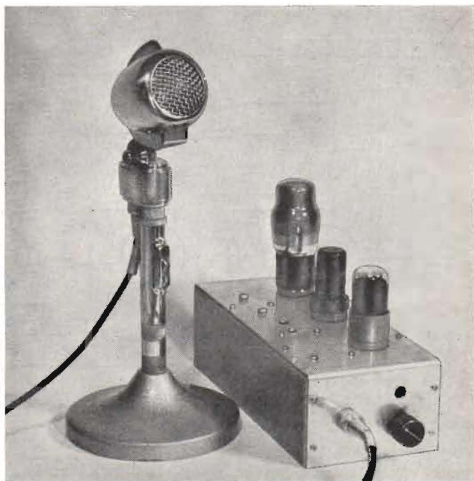
Fig. 2. Den färdiga modulatorens som kan användas för att modulera en 50 W sändare bör vara väl skärmd.
