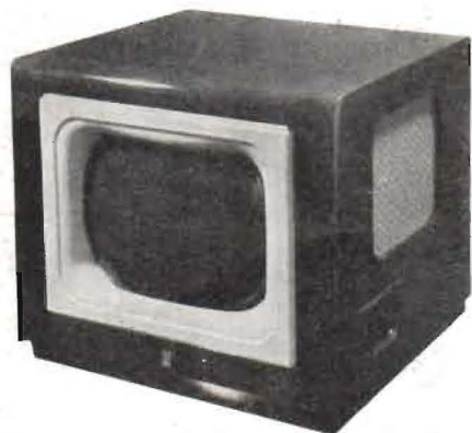
Fig. 2. Engelsk TV-mottagare med 12" rör och »black screen». Pris ca 50 £.
