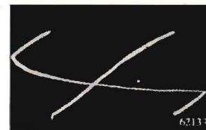
Fig. 19. Den sågtdandformade spänningen, som erhålles över kondensatorn C_5 (jfr fig. 3, PR nr 7).
