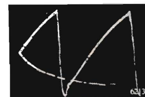
Fig. 22. Den sågtdandformade spänningen över kondensatorn C_{15} (se fig. 3, PR nr 7).
