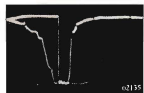
Fig. 23. Spänningen på gallret för utgångsröret för linjeavlänknningen, rör V_4 (se fig. 3, PR nr 7).
