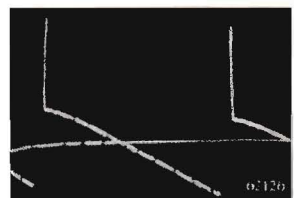
Fig. 21. Spänningen på anoden på utgångsröret för bildfältavlänknningen, pentoddelen för rör V_2 (se fig. 3, PR nr 7).
