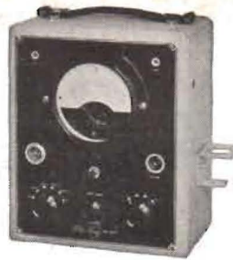
Rörvoltmeter GM 6004 med mätområden för 3, 10, 100 eller 3000 V växel- och likspänning. Frekvensområde 50 p/s - 100 Mp/s. Noggrannhet 3 %. Pris 690 kr.
