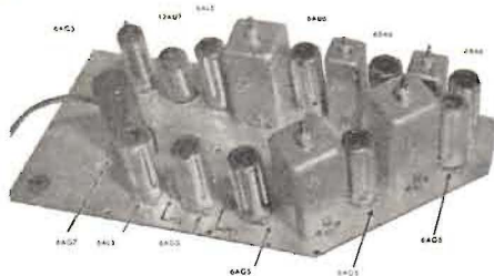
Fig. 60. Amerikansk enhet för TV-mottagare tillverkad av Videodyne Inc. omfattande mellanfrekvens- och detektorsteg samt bildfrekvens- och lågfrekvenssteg för bild och ljud respektive. Räknet från höger till vänster återfinnes i figurens övre del ljudförstärkarstegen med första och andra MF-steg (2x6BA6), AB-steg (6AU6), FM-detektorsteg (6AL5) samt två LF-steg (12AU7) och slutsteg (6AQ5). I figurens nedre del återfinnes vidare bildförstärkarstegen med första t.o.m. fjärde MF-steg (4x6AG5), detektorsteg (6AL5) samt BF-steg (6AG7).
