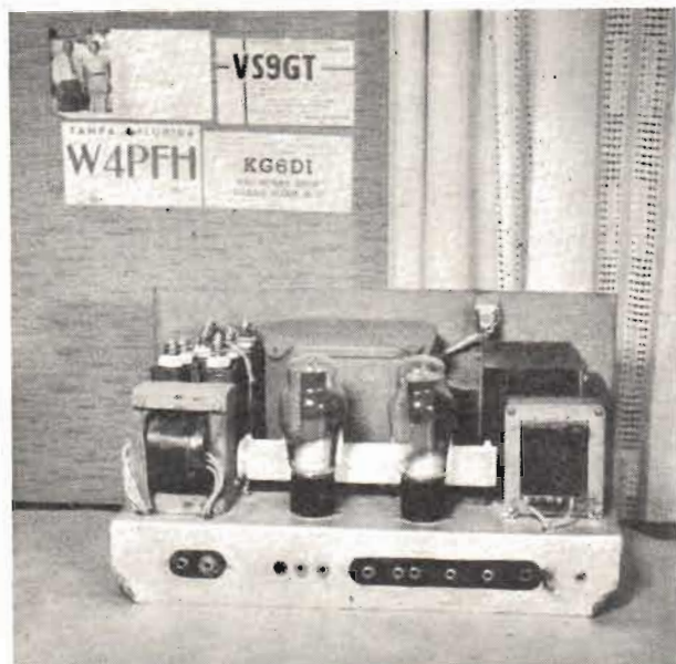
Fig. 12. Högspänningslikriktaren med rören 5U4G, svängdrosseln, filterkondensatorer m.m.
