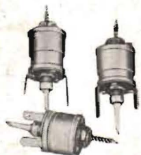
Trimkondensatorer av pressad aluminium. Luftisolerade, koncentriske. Kapacitanser 0 — 20 och 0 — 30 pF. Isolationsmotstånd \geq 30.000 megohm
