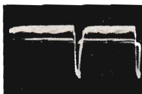
Fig. 72. Oscillogram visande den sammansatta bildfrekvenssignalen under två linjeperioder i lika punkter, 1—5, av kopplingen i fig. 71.
