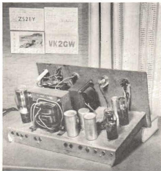
Fig. 13. Statenhet 4 (jfr fig. 1, s. 23 i nr 5/1952). Lågspänningslikriktaren för styr-, buffert- och dubblarstegen samt manöverorganen för krafttillförseln. Dessutom spänningsstabilisator för VFO:n.
