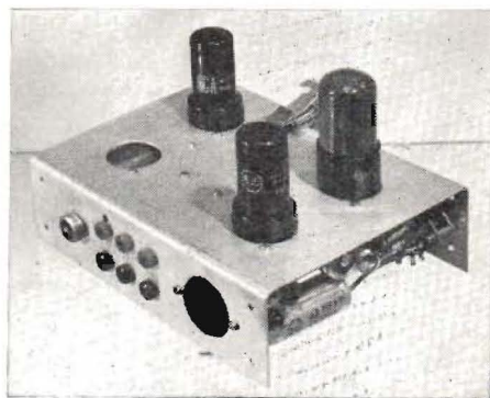
Fig. 8. Förförstärkaren sedd snett bakifrån. T. v. mikrofonkontakt, därefter kontakterna för »IN», »M» och »UT». T. h. strömförsörjningskontakten.
