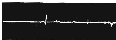
Fig. 2. Oscillogram upptaget med fellokalisatorn.
