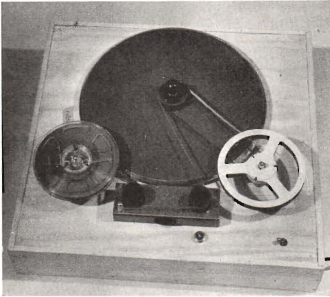
Fig. 18. Bandspelarmekanismen monterad på träskiva och klar för inspelning. I högra hörnet strömbrytare för motorn. Till vänster om denna mikrofonkontakten för in- och avspelningshuvudet.
