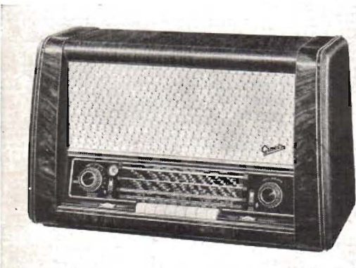
Fig. 1. Typisk västtysk rundradiomottagare (fabr. Graetz ) för LV, MV, KV och UKV, AM/FM, 3 högtalare, 15 W uteffekt och försedd med vridbar, avskärmd ferritantenn med ett HF-steg, 11 rör. Pris 528 DRM.
