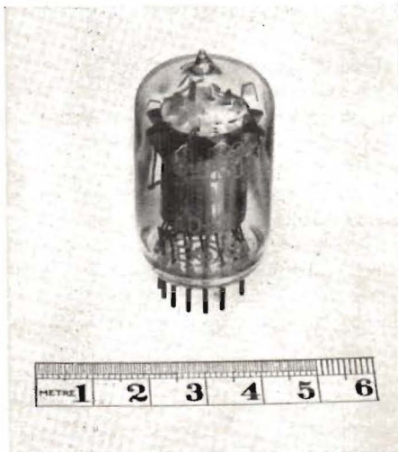
Fig. 5. Dekadräknnorr med magnetisk fokusering (s. k. »trokotron» från Svenska Elektronrör (SER).
