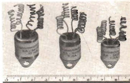
Fig. 5. Instrumentlikriktare (kopparoxidullikriktare) från AB Tudor, Stockholm.
