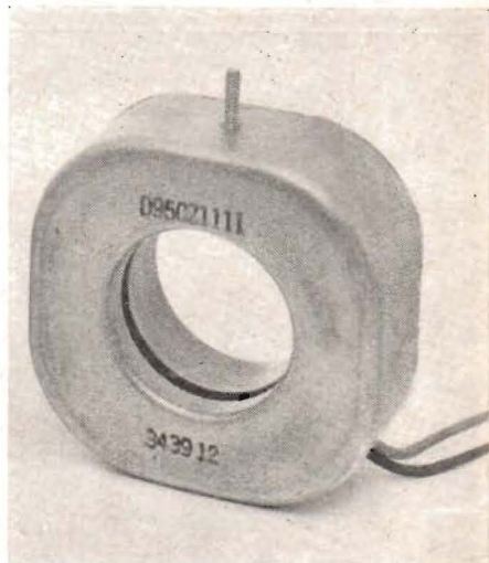
Fig. 6. Avböjningsenhet innehållande två par avböjningspoler för bild- och linjeavböjning. Enheten är här sammanbyggd med fokuseringsmagneten.
