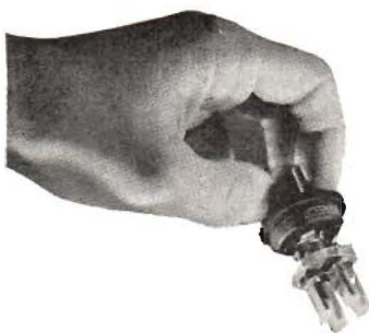
Fig. 14. Slutsteg till tonfrekvensförstärkare. Fyra transistorer ingår men inga andra komponenter!
