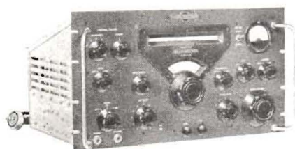
Fig. 1. Trafikmottagare för frekvensområdet 0,54—30,5 Mp/s från Collins Radio Co, typ 51J-3. Mottagaren har 30 frekvensområden om vardera 1 Mp/s, och varje varv på fininställningsskalan motsvarar 100 kp/s.
