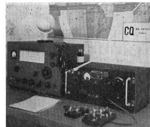
Fig. 1. Nedre raden fr. vänster: S4, C21, S2, C15, nyckeljack, S1. Övre raden från vänster: glödlampa, ant.-genomföring och C23, glödlampa, M1, C3.
