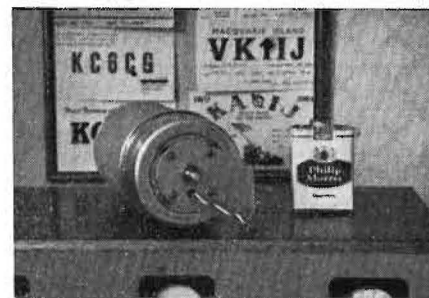
Termosenheten i färdigt skick (t.v.) Termosflaskans »innehåll» sedan flaskan och bakstycket avlägsnats. Observera mellanstycket inskruvat i locket (t.h.)
