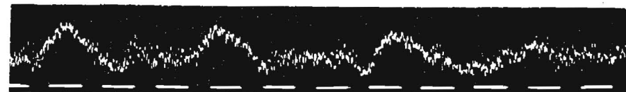
Bild 3. De norrskensavböjda 50 MC-signalerna från W1HDQ registrerades hos W2ZGP. I oscillogrammets nedre kant syns tidstrecken (120 per sekund). Bilden visar alltså variationerna i bärvågens styrka under 1/10 sekund. Verklig snabbfadning! Ytterligare anmärkningar, se texten.
