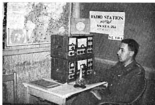
SM5ZS/ZC med sin gamla station bestående av Geloso rx och tx, nu är tx-en en Gonset ssb-exciter följt av ett pa med 4x811. Antenner: Long-wire för 3,5 och 7, dipol och gp för 14, dipol och quad för 21 Mc.
