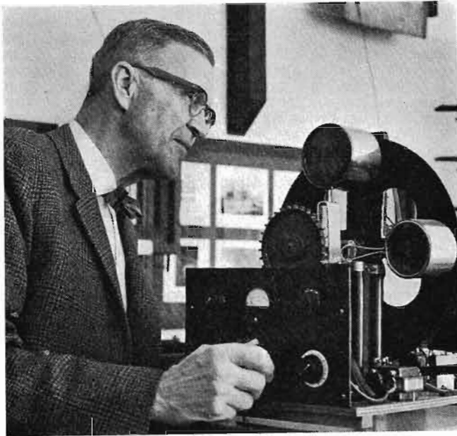
Föreståndaren för Telemuseum, Einar Malmgren, demonstrerar hur en TV-mottagare kunde se ut 1931 — bildrutan var inte större än ett frimärke.
