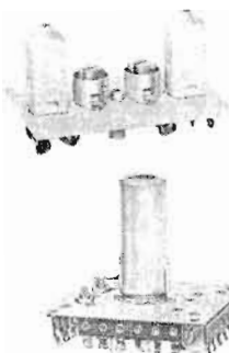
SSB-filter (sid X 10) Med 2, 4 eller 6 kristaller. Konstruera- de för en bandbredd av 3 kHz.
