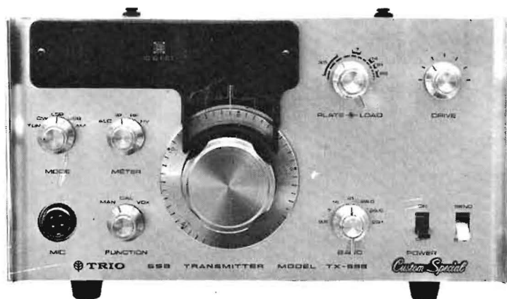
TX-599. Transistoriserad sändare med 3 rör i fläktkyllt driv-slutsteg. Pris 2180:— inkl moms
