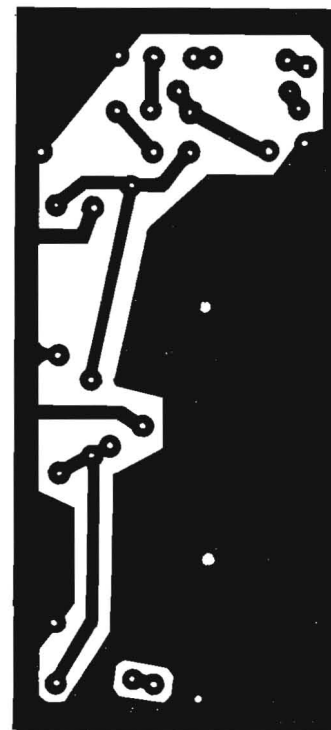
Fig. 3. Förslag till kretskortmönster, skala 1:1.
