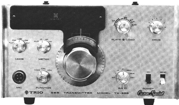
TX-599. Transistoriserad sändare med 3 rör i fläktskyt driv-slutsteg. Pris 1940:– + moms.
