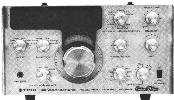
JR-599 Heltransistoriserad mottagare. Kan köras transceivt med TX-599. Pris 1810:— inkl moms
