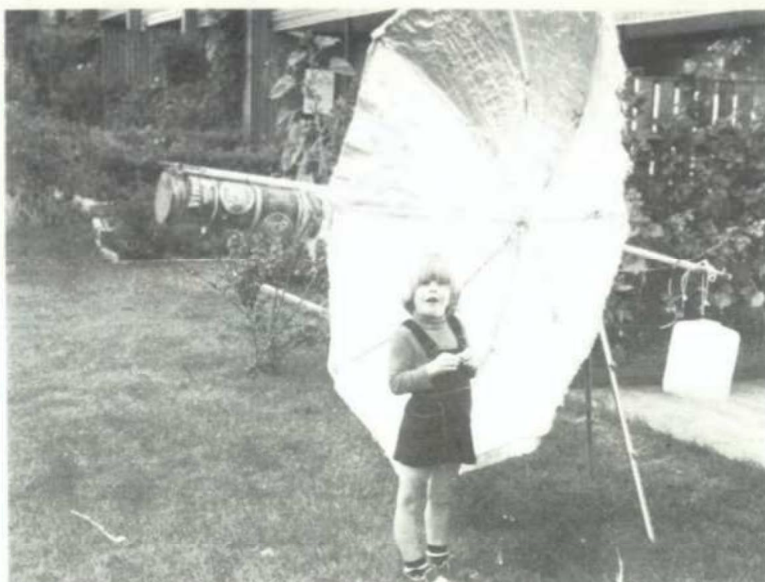
SM0FOB:s portabla parabolantenn gjord av ett solparasoll och aluminiumtape.
