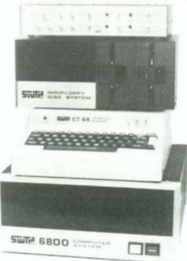
Screen-read-board gör det möjligt att skriva en eller två sidor på CT-64 för att sändas iväg till datorn senare.
