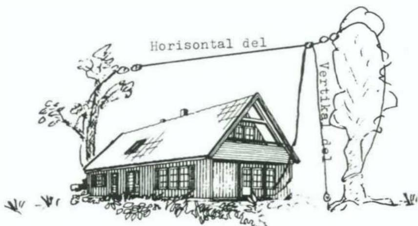
sontella dipolen (2dB sämre) men bättre än den inverterade V antennen (1dB bättre) och betydligt bättre än vertikal dipolen. När det gäller DX förbindelser var inverterade L-antennen inte lika effektiv som den vertikala dipolen (3dB sämre) men betydligt bättre än den inverterade V antennen (3dB bättre).
