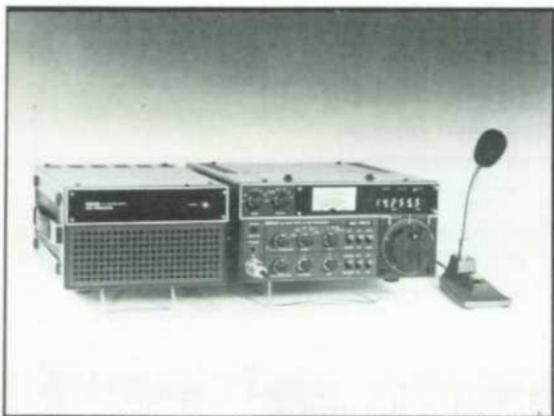
IC701: 10-60 meter 100 W uteffekt SSB/CW/FSK digitalavläst, 2 st VFO RF talprocessor, 2 st CW filter, RIT, Vox, NB, Bandpassstuning. Kan anslutas till ICRM-3. Pris: 8.750:— inkl nätagg och mikrofon.
