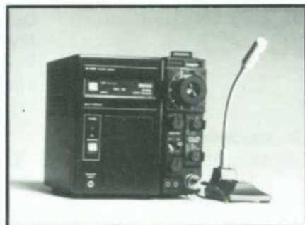
IC202E: SSB/CW transceiver för 2 meter. 3 Watt. Bärbar.
