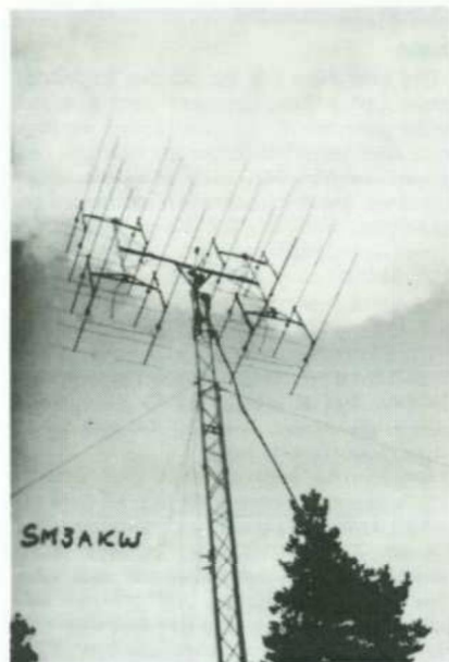
SM3AKW:s fiffiga kombinationsantenn: 32 el. collinjärt för 144 och 16 x 17 el. yagi för 432.
