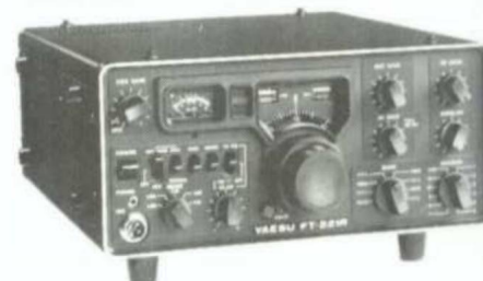
FT-221 R. Sändtagare 20W pep SSB, CW och 5W AM. 144–148 MHz. Heltransistoriserad.
