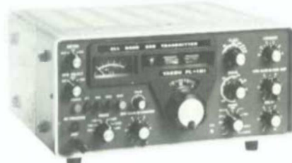
FL-101. Sändare 240W pep SSB, 180 W, CW och 80W AM, RTTY. Endast 3 rör 220V.
