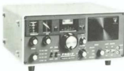
FRG-7. Mottagare av bra klass, täcker 0,5–30 MHz i 30 band, vardera 1 MHz. SSB CW och AM. Fininställningsratt. Dämpsats i 3 steg. Kristallkalibrator 1 MHz.
