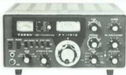
FT-101E. Sändtagare 260 W pep SSB, 180W CW och 80W AM. 12 och 220V. Endast 3 rör, resten halvledare.
