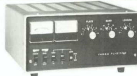
FL-2100B. Linjärt slutsteg 1200W SSB, 800W CW och 600W AM, RTTY. 2 st. rör 572 B. 220 V.
