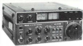
IC-211E: 2m 10W SSB/CW/FM Digitalavläsn. VOX, NB, RIT Tonöppn. SWR-DISC-S-meter En toppstation! (12/220V).
