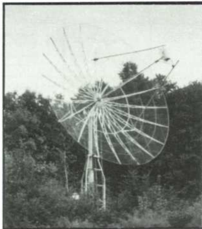
Författarens 8 meters parabol för 432 och 1296 MHz. Foto: SM6FYJ.
