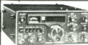
FT 301: 10–160 m, SSB/CW/AM/FSK. 200 W. Med processor, rejekt, RIT, kanalstyrningsmöjlighet. För 12 volt DC. 6.250:–
