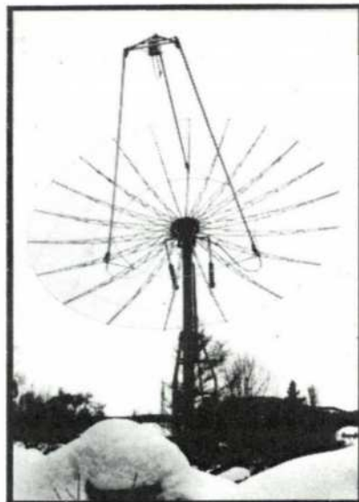
SM6CKU:s 8 m parabol. Ger på 432 MHz 27 dBd gain. På 1296 37 dBd gain.
