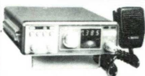
FT-227R: 2 m FM. 20/2 watt. Digital. PLL 5 kHz steg. Tonöppnare. 12 volt DC. 2.350:–
