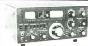
FT 101/277: 10–80 m. SSB/CW/AM. 275 W. Finns med eller utan processor. Inbyggd strömfors för 12/220 V DC/AC. 5.650:–
