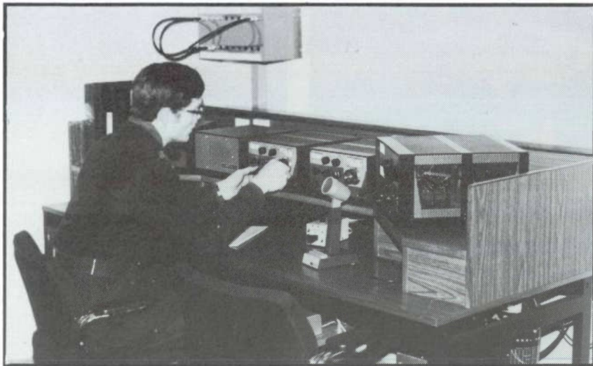
KV-stationen Drake T-4XC, R-4C L-4B samt MN-2000. Antennen är 5-el FB53.
