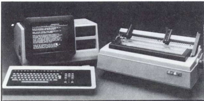
BITSY 1 skrivautomat med primärminne på hela 96000 tecken, 12" skärm med 22 rader 80 tecken, svenska kommandon, skrivaren ger 45 tecken per sekund, klarar papper upp till stående A3, säljs av nystartade DILTEX AB Linköping 013 - 14 66 50.
