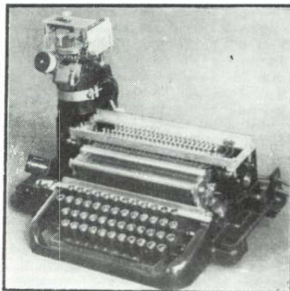
Bild 9. Klaviatursändare för hellskrift med kåpan avtagen.
