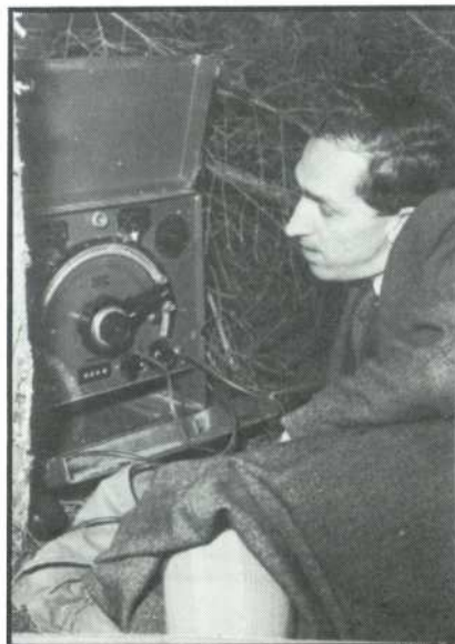
Rävsändaren, en arméns f d 2-wattare. Vid nyckeln SM5AQB.
