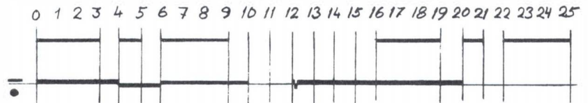
Fig. 1. Sändning av 2 st K med ordmellanrum. Första K:et visar när växling (manipulering) senast måste ske. Andra K:et visar när växling (manipulering) tidigast kan ske.
