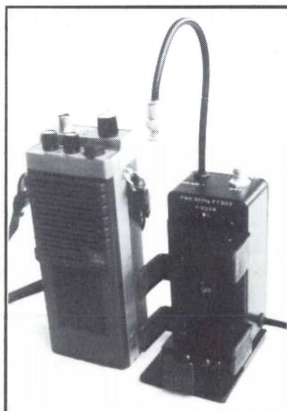
Fig. 1. FT 202 R med tillsats för stationärt eller mobilt bruk. 8 W uteffekt vid 12 matning.
