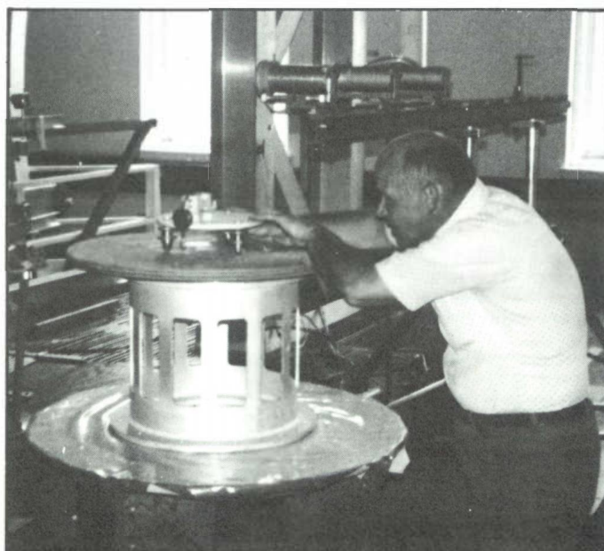
Test av UoSAT magnetometer (Orbit 8/81).
