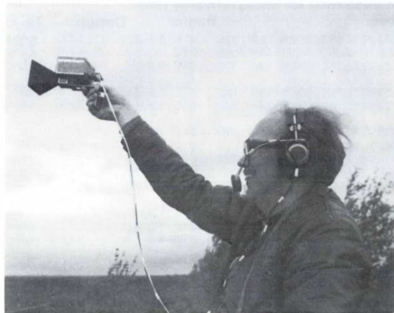
SM5AQJ, Björn testar på 10 GHz med en gunnplexer. I andra änden c:a 20 km bort finns SM5QA. Foto: SMØFOB.
