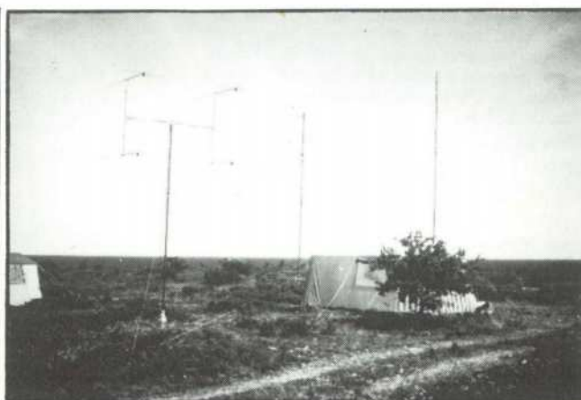
Lägerplatsen. Fr v 4 x 8 el för 2 mb 15 över 15 för 23 cm, därunder 19 el för 70 cm. Till höger hjälpmast för KV-antennen.
